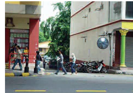
Gambarfoto 7.11 : Contoh penyediaan cermin keselamatan yang diletakkan di lorong atau celah bangunan bagi mengurangkan kadar jenayah di kawasan-kawasan terlindung.
